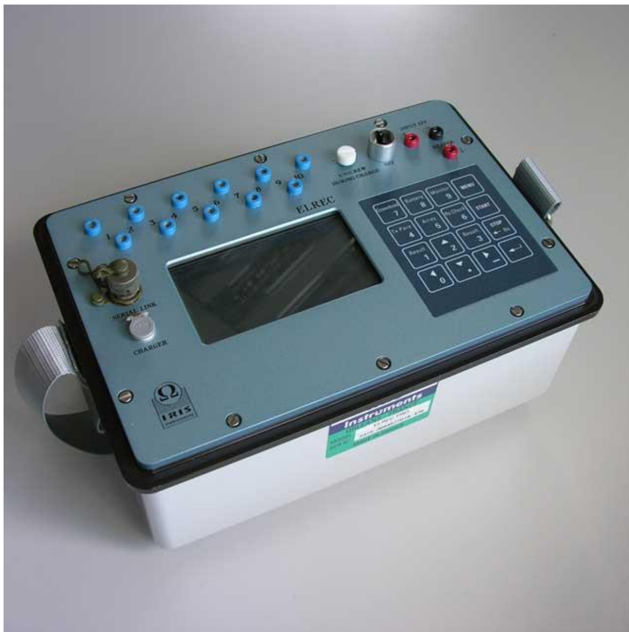
Сурет 3.6 – ELREC PRO өлшеу жүйесі
